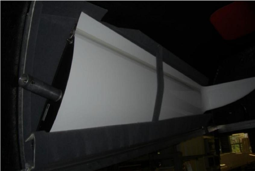
Die Ansteckflügel sind in einer **ganzflächigen Aufnahme** untergebracht. Gesichert mit einem gut gepolsterten Sperrhebel. Bequem im Anhänger ganz hinten, seitlich im Dach. (optional)
