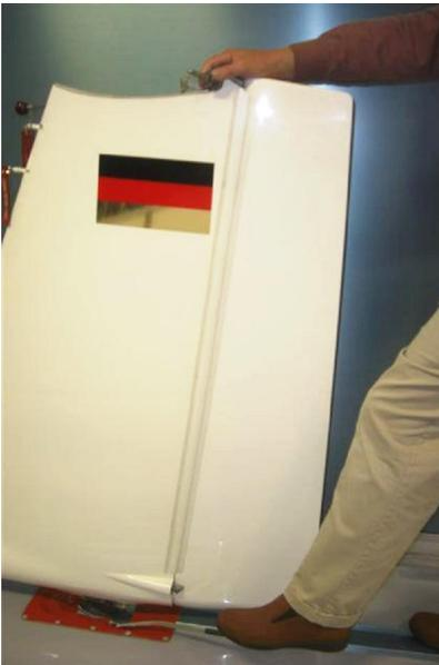
Die **Aushebevorrichtung** für das Spornradö steigen Sie mit dem linken Fuß auf den Hebel . und schon kommt Ihnen der Rumpf Ihres *Arcus* fast von allein entgegen. Komfortabel bei motorisierten Flugzeugen mit hoher Spornlast! (optional)
