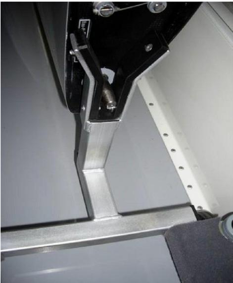
Die Flügelwagen im Anhänger haben eine **zusätzliche Aufnahme (optional)** für den Querkraftbolzen an der Wurzelrippe. Damit lässt sich auch der bogenförmige Tragflügel Ihres *Arcus* sicher und ohne zu kipeln in den Anhänger schieben.
