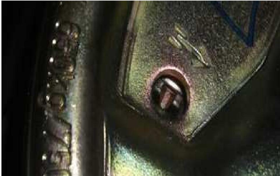
Durch die zweite, innere, Öffnung sehen Sie das Zahnrad zur Bremseinstellung. Daneben eingepreßt ist der Pfeil der Drehrichtung zum nachstellen.
