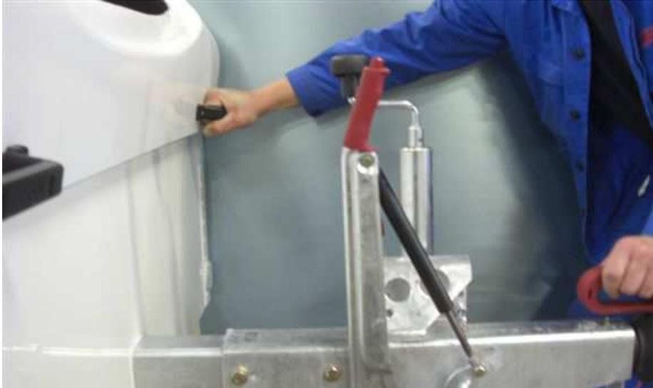
Nachdem Sie den Anhänger wieder auf die Räder gestellt haben, lässt sich die Bremseinstellung leicht prüfen. Ziehen Sie dazu den Handbremshebel nach hinten / oben und schieben Sie den Anhänger rückwärts. Dabei muss der Handbremshebel **von selbst bis zur 90° Stellung (nicht weiter!)** relativ zum Zugrohr zurückgehen!
