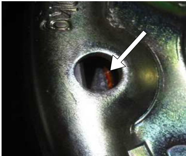
Durch die äußere Öffnung können Sie den Zustand der Bremsbeläge prüfen. Wenn der Bremsbelag bis zum Ende der Schräge ( Pfeilspitze ) abgenutzt ist, muss er erneuert werden.
