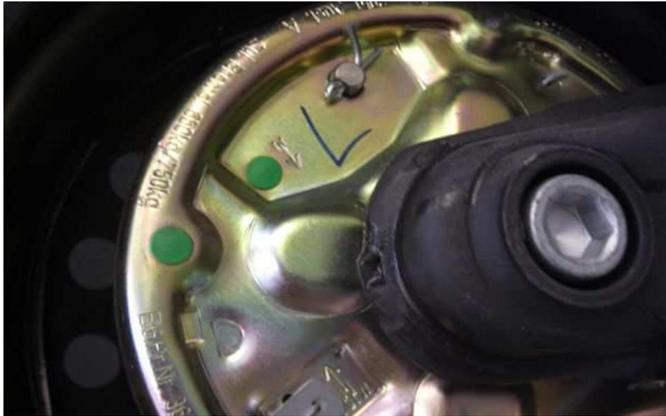
Öffnen Sie nun die beiden grünen Kunststoffverschlüsse mit einem kleinen Schraubendreher. Im Bild die Bremstrommel auf der linken Anhängerseite.
