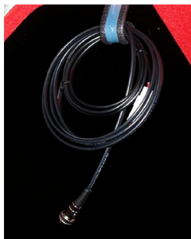
Das Ladekabel im Anhänger (C). Mit Sicherheitsstecker, der trennt, falls es irgendwo klemmt. Mit dabei: der passende Ladestecker für Ihr Flugzeug.
