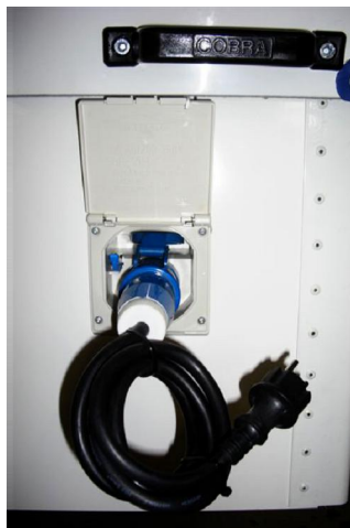
Der Stromeingang (U) für 220 ( 110 ) Volt an der Anhänger ó Vorderseite. Mit Adapterkabel (V) und 220 V Stecker Ausführung nach VDE
