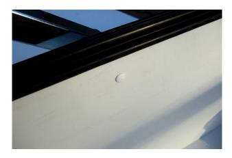
Schließen Sie das äußere Loch mit dem Plastikstopfen und montieren das Abschluss - U und das Spannschloss.
