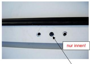
Entfernen Sie den alten Bolzen und weiten Sie das Loch auf Ø 13 mm nur durch das innere Profil.
