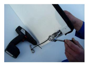
Zunächst entfernen Sie das Spannschloss und bohren Sie die Niete des U-Profils aus. Dann entfernen Sie das U-Profil.
