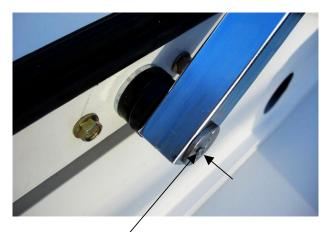
Schrauben Sie nun alles zusammen. Die 8 mm Schruaben durch die äußeren Löcher. Den Hauptbolzen und die 40 mm U-Scheibe mit der 19 mm Mutter anschrauben. Nun die schwarze Hülse aufstecken (unterschiedliche Innendurchmesser).
