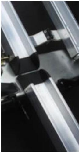
Die Mittelschienen (optional). Ideal für Motorsegler.
