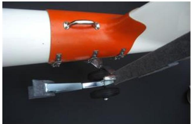
...und die Schleppstange senkrecht in das Querrohr des Kullers Einstecken.
