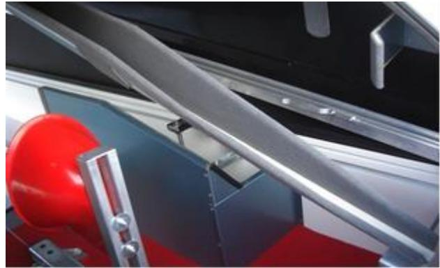
Ansteckflügelhalter schwenkbar, ein und ausgeklappt (optional). Erlauben das bequeme Be- und entladen der 18 m Ansteckflügel durch die Frontklappe.
