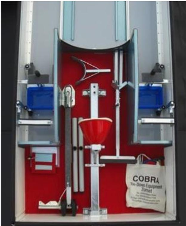
Das Ablagefach (Serie) in Ihrem ASH31Mi Anhänger: Großzügiger Platz für Ihr Zubehör. Ganz vorn 1200 mm breit und 580 mm lang, für die Schleppstange oder Flügelstütze in der Mitte verlängert auf 1400 mm bei einer Breite von 570 mm. Mit hohen Seitenwänden zum Schutz Ihrer Tragflächen. Neben der Schleppstange sehen Sie die Tragegriffe für den Innenflügel Ihrer ASH 31Mi (Serie).
