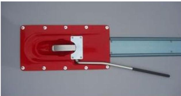
Die Aushebevorrichtung für das Spornrad. Steigen Sie mit den linken Fuß auf den Hebel – und schon kommt Ihnen der Rumpf Ihrer ASH 31Mi fast von allein entgegen. Komfortabel bei motorisierten Flugzeugen mit hoher Spornlast (optional)!
