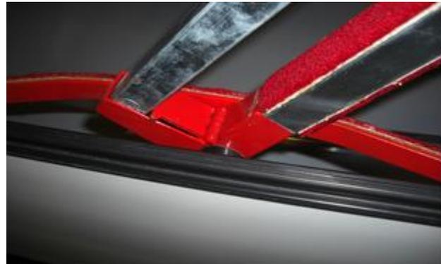
Mit einer Fingerbewegung, durch umlegen eines Scharniers, schalten Sie die Kraft der zweiten Gasfeder aus oder ein.
