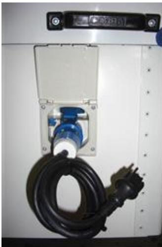
Der Stromeingang (U) für 220 (110) Volt an der Anhänger-Vorderseite. Mit Adapterkabel (V) und 220 V Stecker Ausführung nach VDE.
