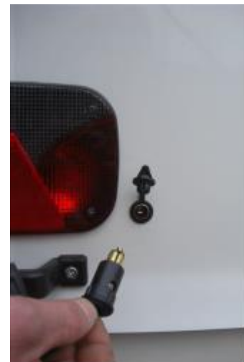
Die Steckdose hinten außen. Mit Ladekabel 4m lang und dem passenden Stecker für Ihr Flugzeug (H).
