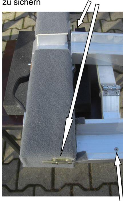
Nehmen Sie dann die Schraubzwingen ab und setzen Sie einen weiteren Niet von oben, in der rechten Ecke des Schienengrundes.
