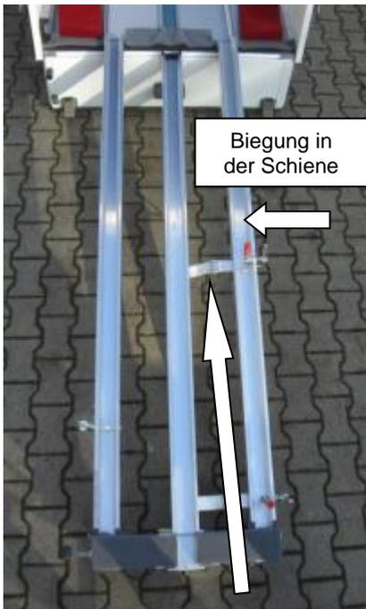
Bitte legen Sie die Mittelschiene, so wie im Bild zu sehen, genau mittig in die Rampe und klemmen Sie die Scharniere mit zwei Schraubzwingen von unten an die rechte Schiene. Das vordere Scharnier muss hinter der Biegung der Rumpfwagenschiene befestigt werden.
