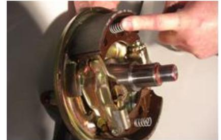
Die Bremsbacken sind schwimmend aufgehängt und nur durch die Haltefedern gesichert. Um das Aufstecken der Bremstrommel zu erleichtern, drehen Sie bitte das Einstellzahnrad ganz zurück und zentrieren Sie Bremsbacken nach Augenmaß von Hand.
