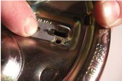
5. Montieren Sie die neuen Bremsbacken wie im Bild ersichtlich vor. Verwenden Sie unbedingt auch die beiliegenden neuen Federn.
