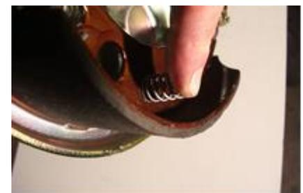
4. ...bei gleichzeitigem Wegschieben des Gegenbleches auf der Rückseite der Bremstrommel. Bowdenzug aushängen und die alten Bremsbacken entnehmen.
