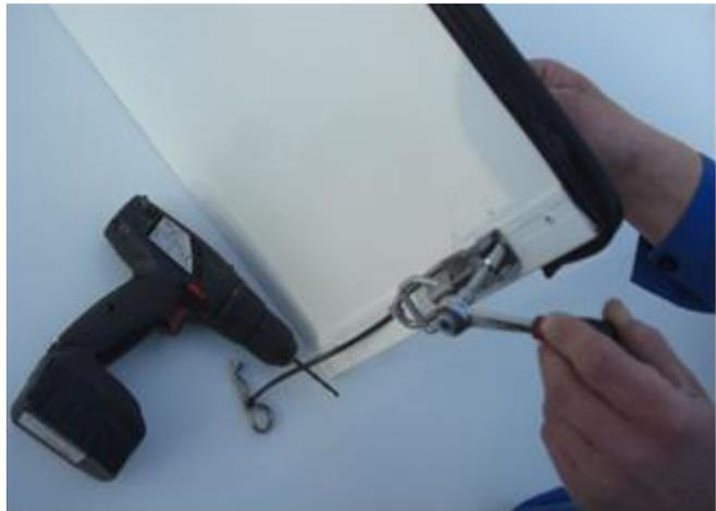
2. Entfernen Sie den alten Bolzen und weiten Sie das Loch auf  $\varnothing 13$  mm - nur durch das innere Profil!
