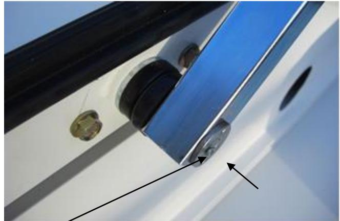
5. Schließen Sie das äußere Loch mit dem Plastikstopfen und montieren das Abschluss-U und das Spannschloss.
